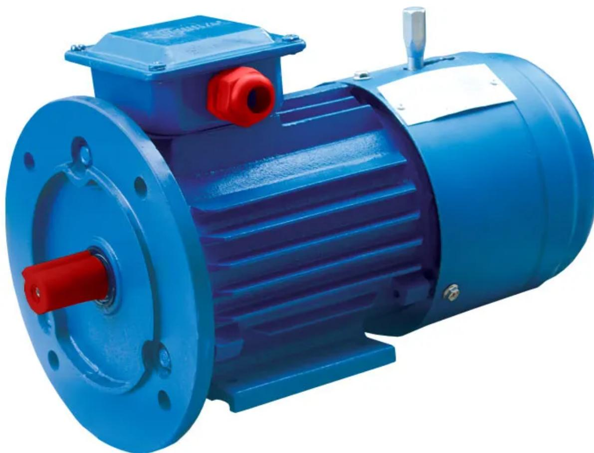
Электродвигатель со встроенным электромагнитным тормозом предназначен для работы в режиме S4 с продолжительностью включения ПВ40% от сети переменного тока 50Гц, напряжением 380V (220, 660V). Стандартная степень защиты - IP54, климатическое исполнение и категория размещения - УЗ. Время растормаживания (включение электромагнитного тормоза) - не более 0,02 с. Время отключения тормоза - не более 0,1 с. Возможна комплектация ручным растормаживающим устройством (ручкой растормаживания).
