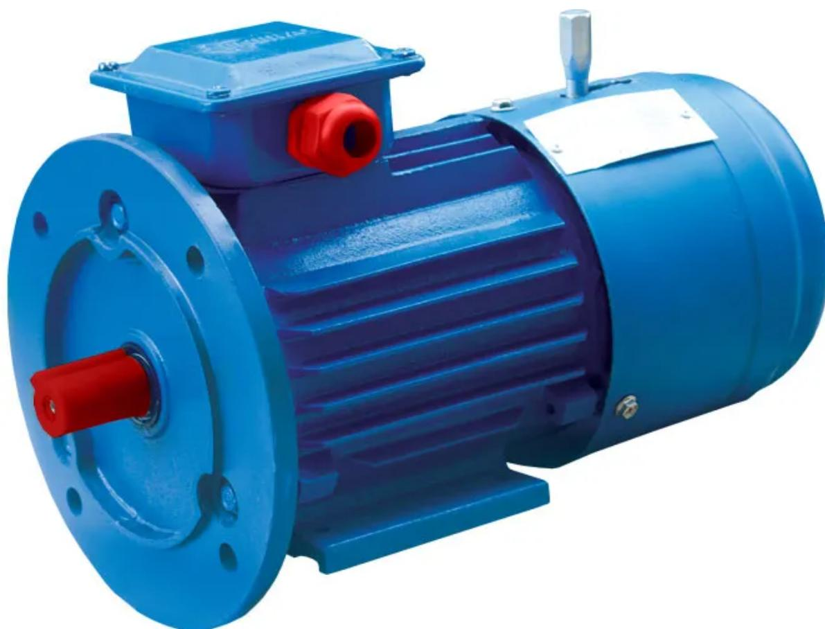
Электродвигатель со встроенным электромагнитным тормозом предназначен для работы в режиме S4 с продолжительностью включения ПВ40% от сети переменного тока 50Гц, напряжением 380V (220, 660V). Стандартная степень защиты - IP54, климатическое исполнение и категория размещения - У3. Время растормаживания (включение электромагнитного тормоза) - не более 0,02 с. Время отключения тормоза - не более 0,1 с. Возможна комплектация ручным растормаживающим устройством (ручкой растормаживания).
